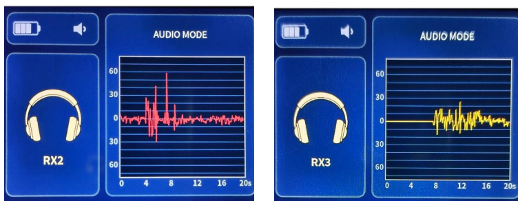
Figura: Características do áudio harmônico de junções falsas, como semicondutores e junções metálicas enferrujadas após a derivação
